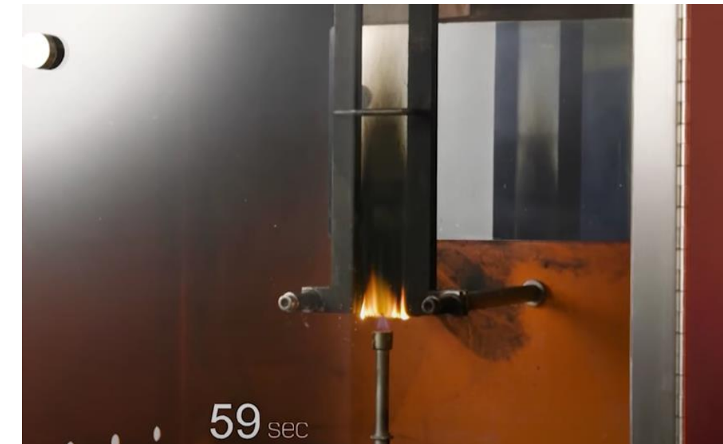
Brandtest van glas voor spiegel's in vliegtuigcabine
